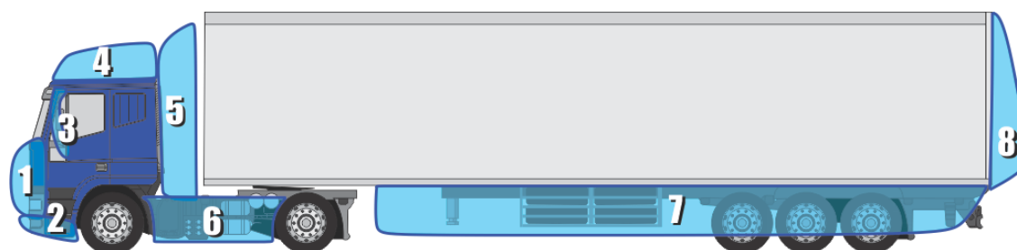
Figura 8. Posibles mejoras aerodinámicas en un vehículo pesado
